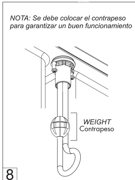
*NOTA: Se debe colocar el contrapeso para garantizar un buen funcionamiento*
