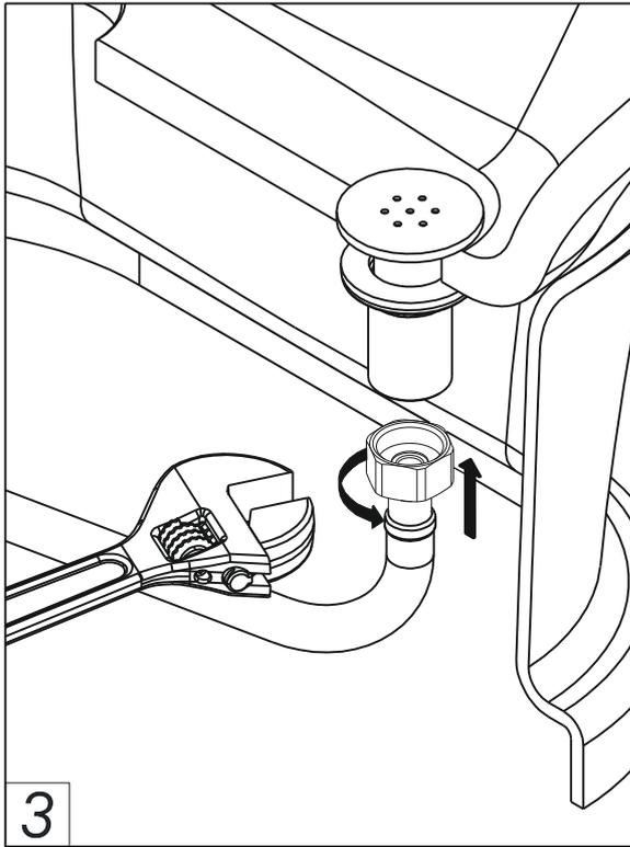
Instalación de sopapa / Drain installation
