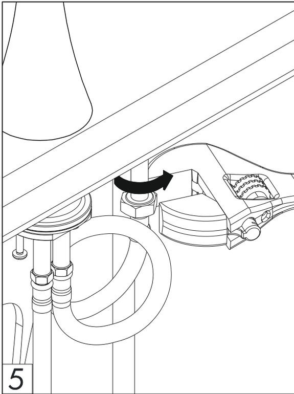
Instalación de la lluvia bidé / Spray installation.
