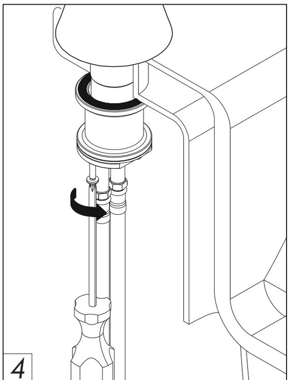
Instalación del volante transferencia / Diverter Handle installation.
